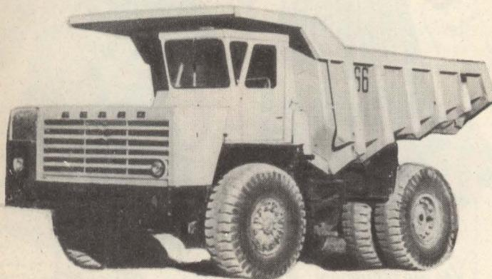
Самосвал БЕЛАЗ-540А поднимает 27 тонн сыпучего груза. Есть грузовики и помощнее. Их делают тоже в Белоруссии, на Минском автомобильном заводе. Но самосвал, который показан на снимке, не только могут, он еще и маневрен, как маленький юркий «Запорожец».
