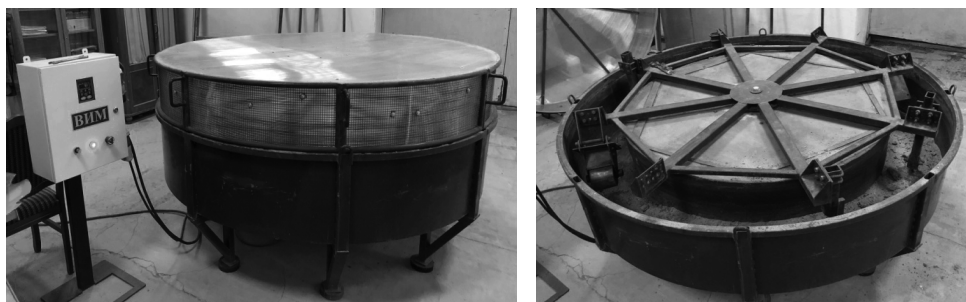
Рис. 2. Круговой почвенный стенд
