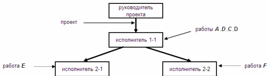
Рис. 7. ДЕКОМПОЗИЦИЯ ПРОЕКТА, РЕАЛИЗУЕМОГО ПО СЕТЕВОЙ ДИАГРАММЕ НА РИС. 6
