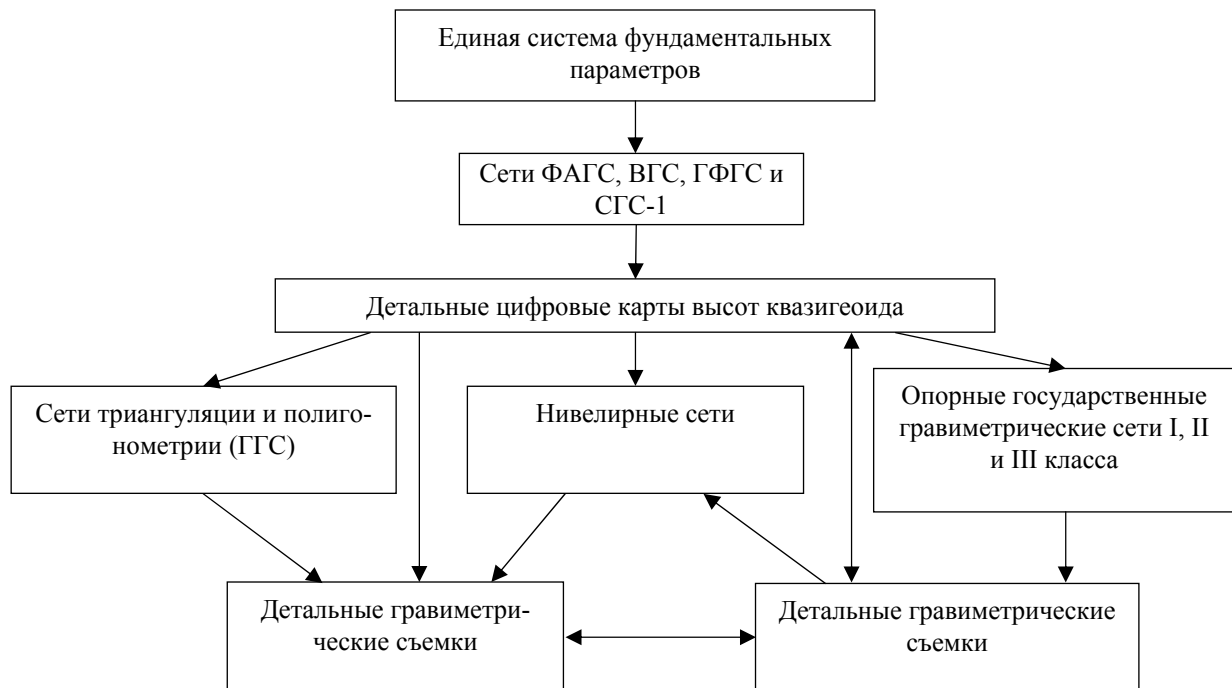
Рисунок 2. Новая структура системы геодезического обеспечения на основе одной системы фундаментальных параметров [8]
