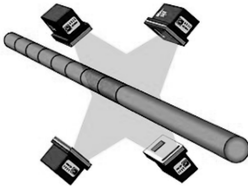
Рис. 1. Расположение датчиков в автоматизированной системе Dimension control and surface analysis of hot rolled
