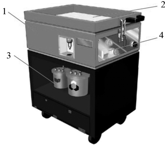
Рис. 2. Стенд для производства композитов с МГП: 1 — столешница, 2 — МГП, 3 — емкости со связующим, 4 — панель управления
