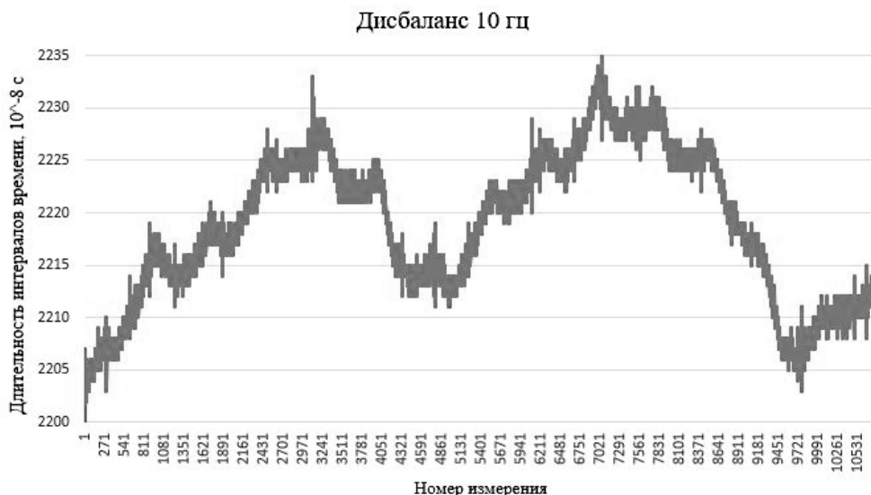
Рис. 4. Хронограмма вращения системы с искусственно внесенным дисбалансом
