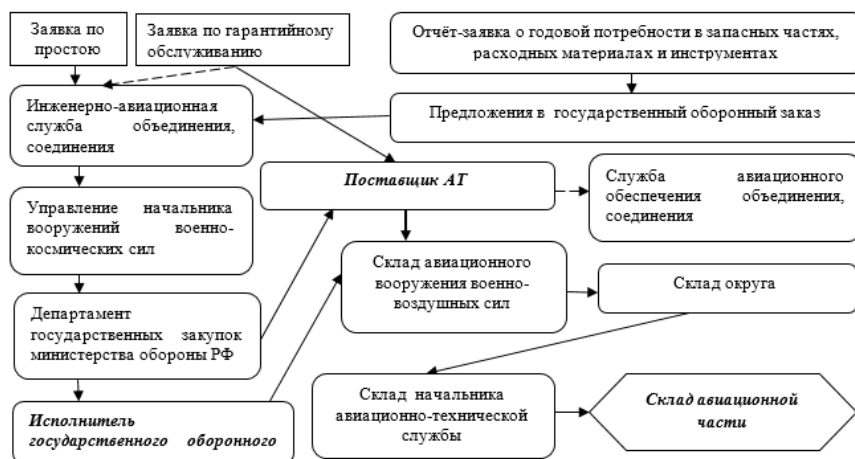
Рисунок 3. Порядок снабжения воинской части необходимым объемом запасных частей, расходных материалов и инструментов
